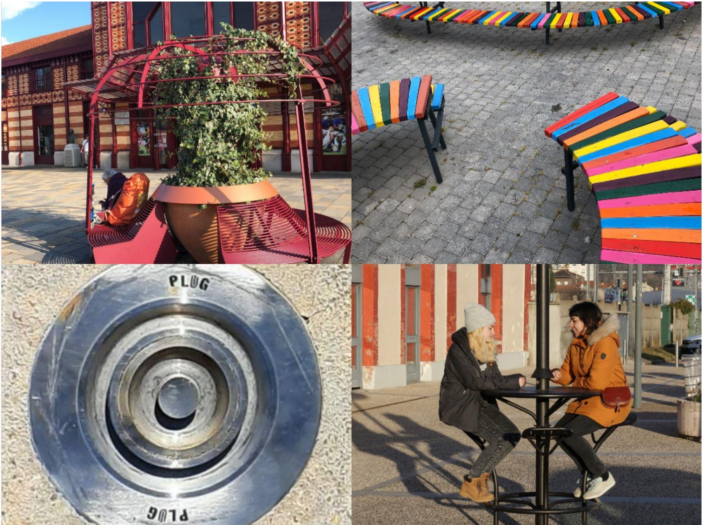
Der Plug ist eine Art Adapter, der in den Boden einbetoniert ist und durch den verschiedene Stadtmöbel befestigt werden können. | Fotos: Kathrin Faltermeier / Zukunftswerk; Foto rechts unten: Cité du Design Saint-Étienne
